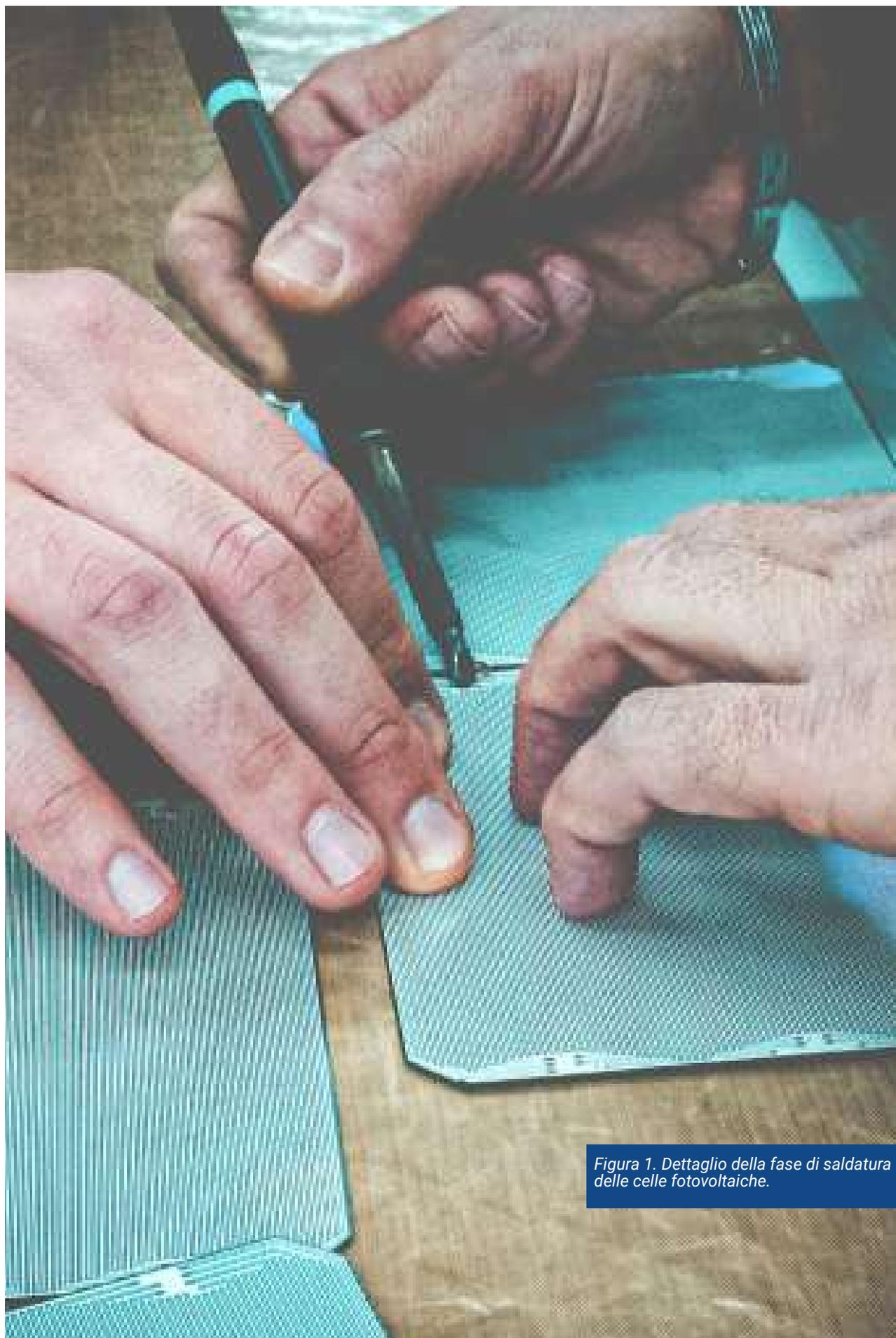
*Figura 1. Dettaglio della fase di saldatura delle celle fotovoltaiche.*
