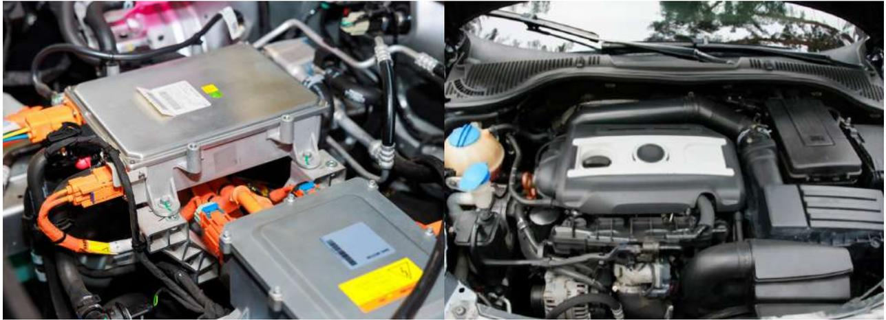
Figura 2. Cofano motore di un autoveicolo BEV e di un autoveicolo ICE.
