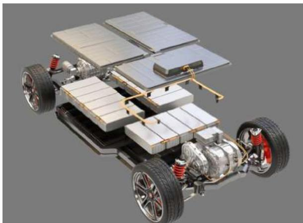
Figura 1. Chassis di un autoveicolo elettrico di principio con evidenza di due power train e delle batterie.
